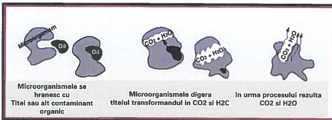
Figura 3. Prezentarea schematică a modului de acțiune a bacteriilor pentru degradarea hidrocarburilor petroliere
