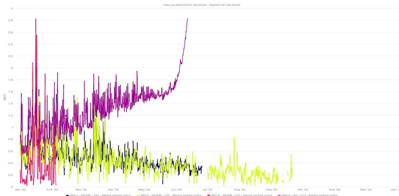
Din analiza datelor obținute din monitorizarea **CO**, în anul 2022, se constată că valorile maxime zilnice ale mediilor concentrațiilor pe 8 ore, s-au situat **sub valoarea maximă zilnică pentru protecția sănătății umane** ( $10\text{ mg}/\text{m}^3$ ).
