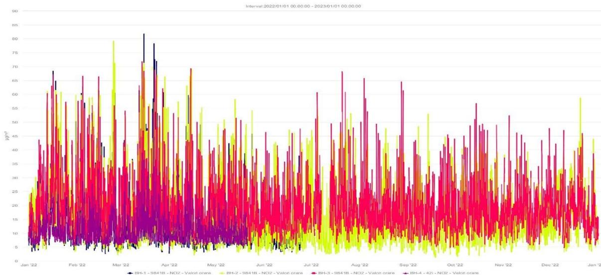
La nivelul anului 2022, *valorile de dioxid de azot* determinate au fost **în limitele admise**. Se poate observa din graficul de mai sus că valorile de NO<sub>2</sub> determinate în toate cele 4 stații sunt constant mai mari-aceste stații fiind în sfera de influență a unui trafic rutier intens.
