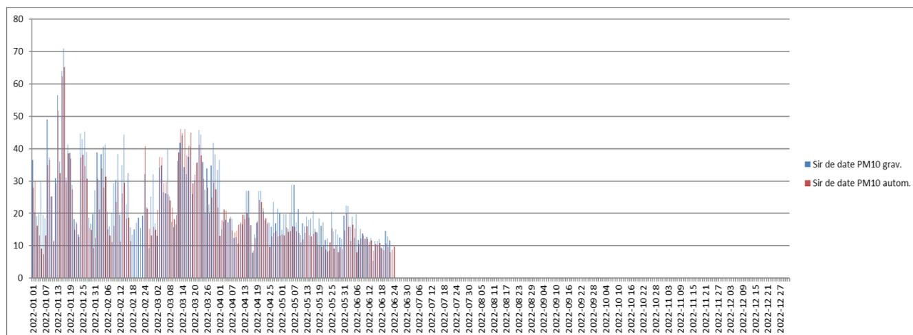
*Stația BH<sub>2</sub>, cu determinări de  $PM_{10}$  (nefelometrice) și gravimetric.*
